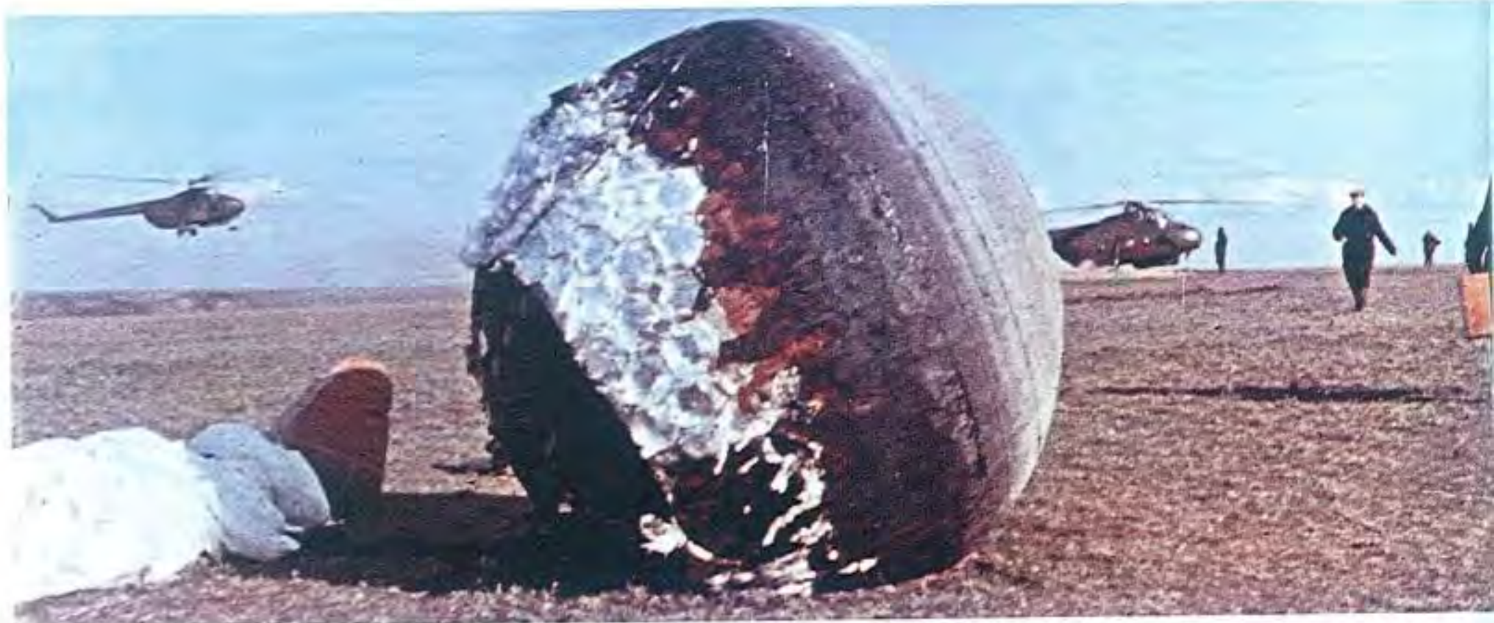
▲ Capsula Vostok I după aterizare. Suprafața este complet carbonizată datorită frecării cu aerul la reîntrirea în atmosferă. În stânga capsulei se află parașuta.
